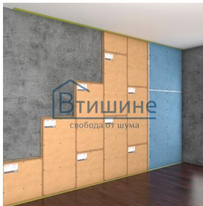
Индекс улучшения изоляции воздушного шума дополнительной конструкции  $\Delta R_w \approx 9,0$  дБ\*
